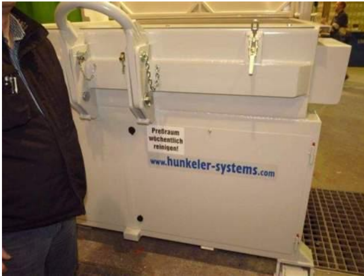
Bild: Wartungstür mit Vorgabe zur wöchentlichen Reinigung
